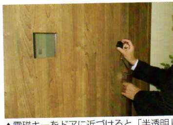
▲電磁キーをドアに近づけると「半透明」の小窓が「透明」に。離れると、確実に「半透明」に切り替わり、スイッチの切り忘れの心配も不要だ
