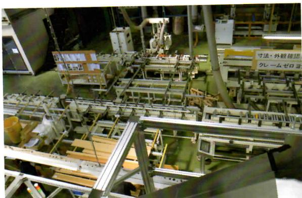
▲ライン後半。枠部材は縦枠材、鴨居材と必要な加工を経て梱包ステーションへと集められ、物件ごとにセットされる
