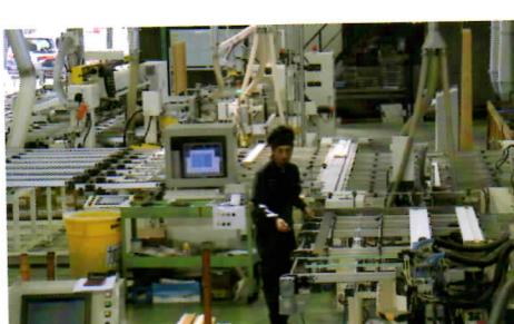
▲枠部材投入。1人で枠部材料の目視検品をしながらパソコン情報からQRコードラベルを出力して1本1本の材料に手貼りしてラインへ投入する
